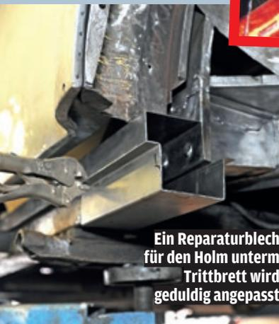
**Ein Reparaturblech für den Holm unterm Trittbrett wird geduldig angepasst**
