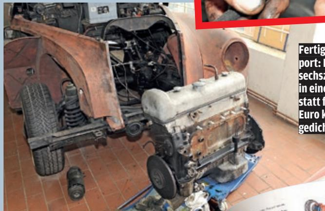
**Fertig zum Transport:** Der ölige Reihen-sechszylinder wird in einer Spezialwerkstatt für rund 800 Euro komplett neu abgedichtet
