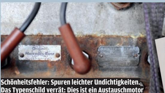
**Schönheitsfehler:** Spuren leichter Undichtigkeiten. Das Typenschild verrät: Dies ist ein Austauschmotor
